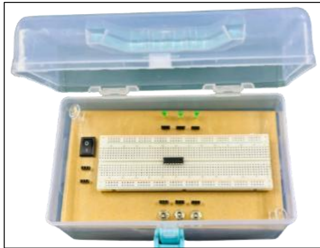
Rajah 1: Pandangan dalam LoGIT yang menempatkan komponen dan breadboard
