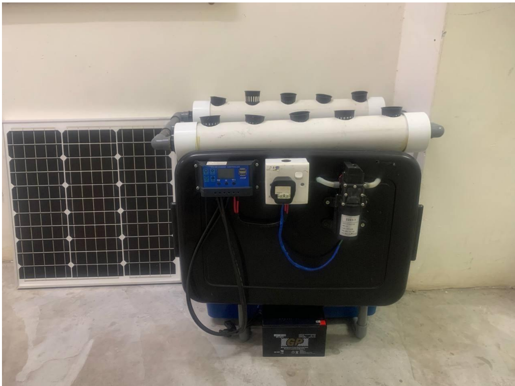
Rajah 2 : Paparan utama bagi sistem solar akuaponik.
