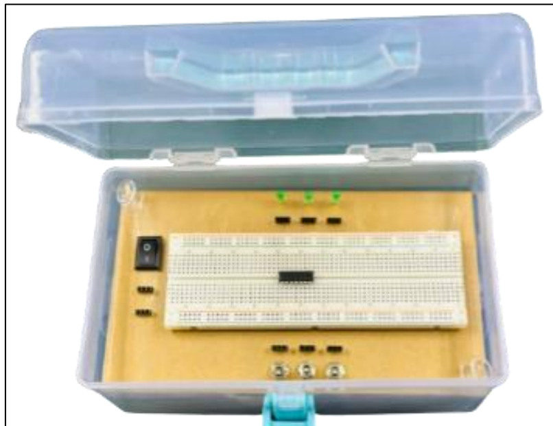
Rajah 1: Pandangan dalam LoGIT 2.0 yang menempatkan komponen dan breadboard
